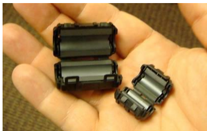
Obr. 1: PQube 3 splňuje všetky požiadavky noriem IEC týkajúcich sa VF emisie a citlivosti, ako absorbovanej tak vyžarovanej. Pre ďalšie zvýšenie ochrany je možné použiť základné feritové prvky pre zníženie rádiofrekvenčného vyžarovania. Napríklad Panasonic KRCBC160928B a KRCBC130714B.
