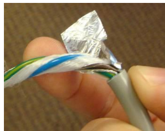
Obr. 2: Pre zníženie rušenia napájacím modulom PM1 je možné použiť kábel s tienením.
